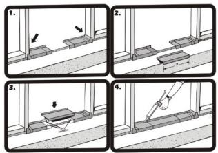
**Nota:** Use solo el cemento de PVC provisto en el kit de la solera inferior para pegar las piezas. Para sellar la solera inferior con el piso utilice un sellador de polímero híbrido, elastómero, o de poliuretano de alta calidad; Therma-Tru recomienda Quad Max de la marca OSI. No aplique sellador a la parte baja de la solera inferior.
